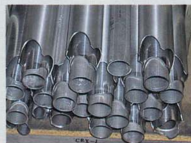
Trubky připravené ke stavbě rámu CRX
